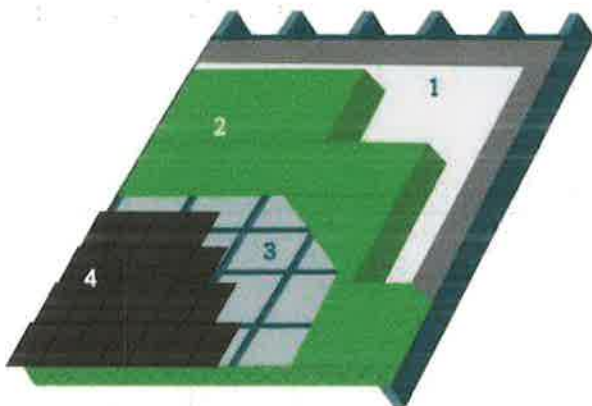
1. Dampscherm | 2. Isolatie | 3. Onderdak | 4. Dakbekleding
